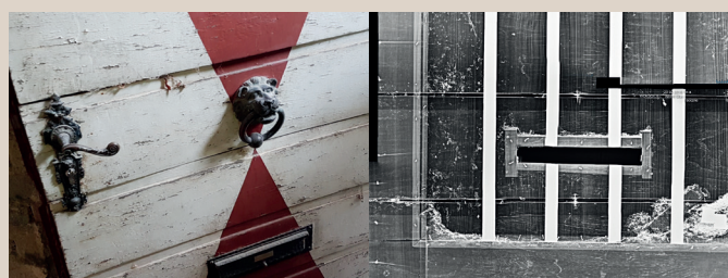
Badanie obrazowe RTG stolarki zabytkowej obiektu Schloss Türnich w Niemczech
